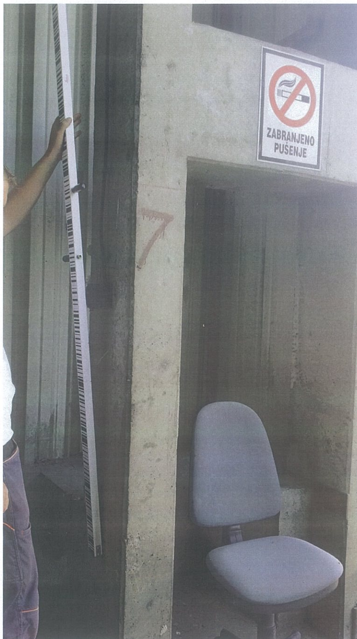
Слика 5.8 Репер бр.7 и препрека због које није било могуће поставити летву за читање
